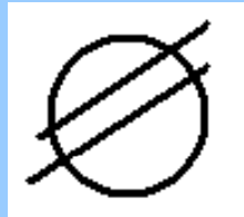
Contacto múltiple en muro
